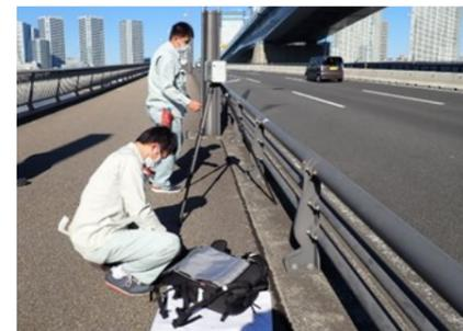
地上レーザスキャナーを用いて、三次元点群データを構築できます。また、地形情報を様々な角度から面的に確認することが可能です。今までの測量作業と比較し、工期の短縮・人員の削減も実現できます。
